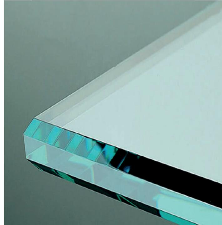
Es el pulido de los cantos lineales realizado con una máquina especializada (rectilínea) con muelas abrasivas, pasando de áspero y cortante a orillas pulidas con brillos o mateadas.
