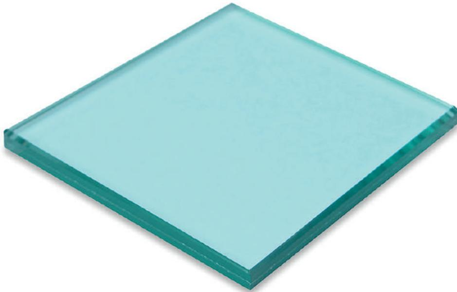
El vidrio laminado azul verdoso está hecho de dos capas de vidrio claro y una película de Butiral de Polivinilo (PVB) azul verdoso. Su capa intermedia alcanza los 1,52 mm de espesor, después del calentamiento y la aplicación de presión en las dos capas de vidrio. Creando un producto resistente y de gran utilidad para el área de la construcción.
